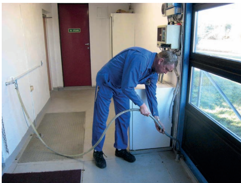
Figur 23. Rengjøring av sugeslangen før prøvetakingen kan starte
