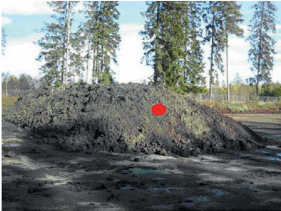
Figur 4. En stikkprøve fra en slamhaug representerer bare slamkvaliteten i prøvetakingspunktet
