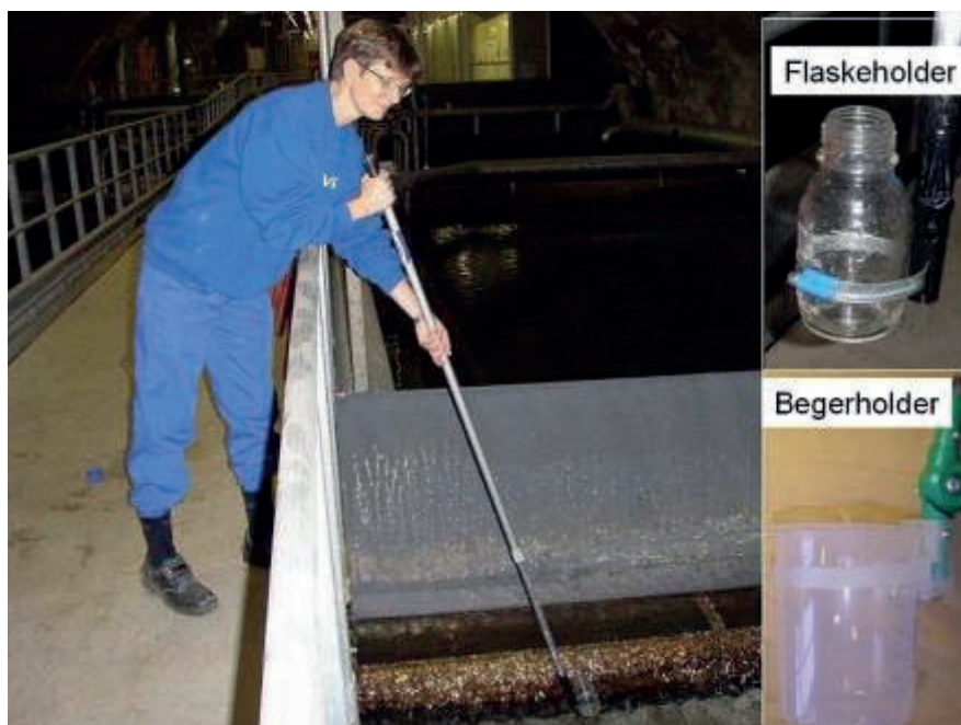
Figur 9. Manuell prøvetaking av avløpsvann – bruk av teleskopstang og flaske- eller begerholder
