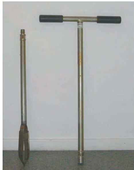
Figur 20. Vanlig benyttet prøvetakingsutstyr ved manuell prøvetaking av slam
