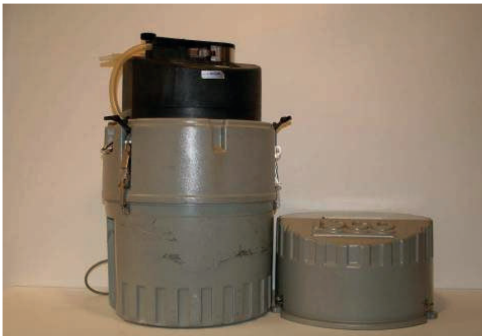
Figur 11. Transportabel automatisk prøvetaker for avløpsvann
