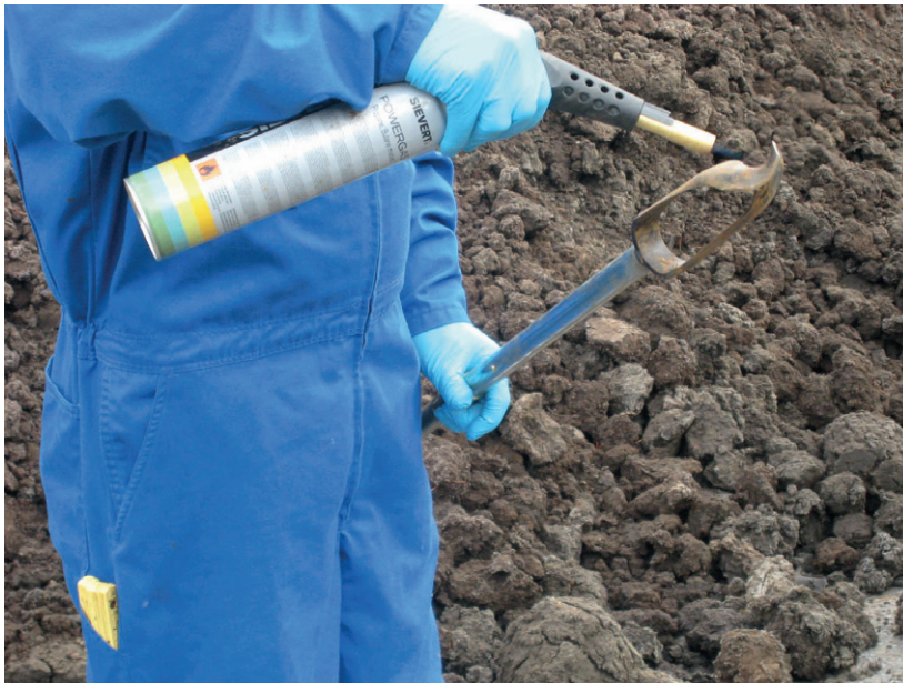
Figur 22. Avbrenning av prøvetakingsutstyr før uttak av prøver som skal analyseres på mikrobiologiske parametere
