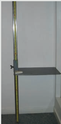
Justerbar plate for å simulere ulike oppstuvninger under ekkoloddet
