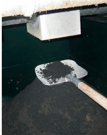
Figur 33. Prøvetaking av avvannet slam på enden av en transportskrue
