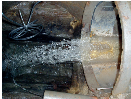
Figur 28. Utstyr for måling av vannføring i delvis fylte rør
