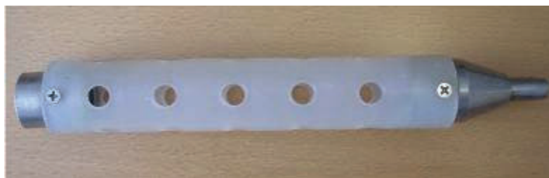
Figur 15. Munnstykke som kan festes på sugeslangen
