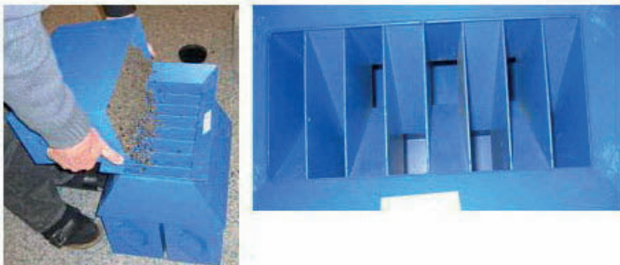
a) Bruk av prøveneddeler b) Toppen av prøveneddeleren
