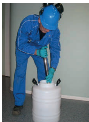
Figur 32. Innholdet i primærprøvebeholderen må blandes godt (venstre). Eksempel på redskap for omrøring og uttak av sekundærprøve (høyre)
