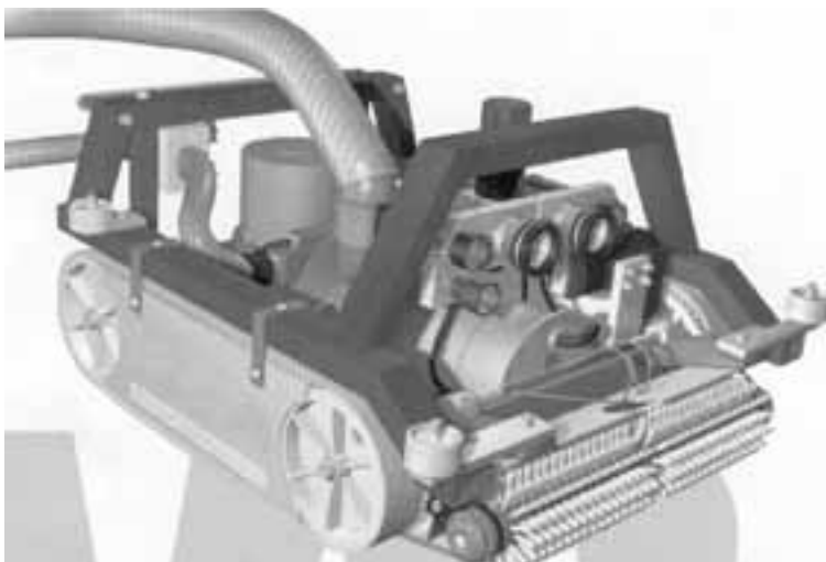
Figur 9.1: Tegning av undervannsfarkost /22/. Farkosten har påmontert lys, kamera og sonar og styres med joysticks. Arbeidene utføres av spesialfirma. Det oppgis av et slikt firma at en kan slamsuge 50-100 m 2 i timen.
