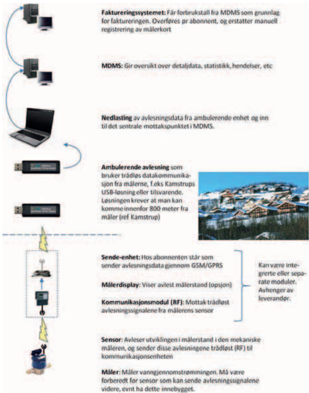
Figur 20: Foreslått struktur for områder med dårlig GSM/GPRS-dekning, men med brukbar tilgjengelighet
