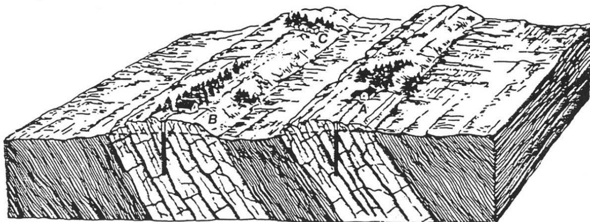
Figur 4.13. Forurensning av grunnvannsmagasin med lagdelte oppsprukne bergarter
