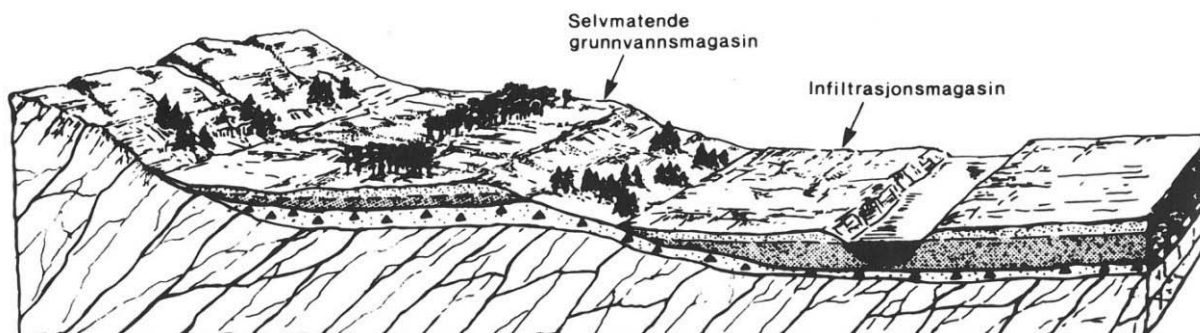
Figur 4.1. Beliggenheten av selvmatende magasin og infiltrasjonsmagasin i en dalbunn
