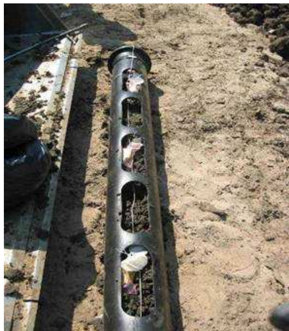
Figur 1. Prøvetakingsrør – Plassering av parasitteggposer og temperaturloggere.
