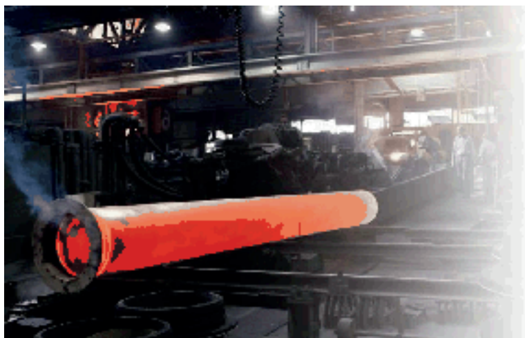
Figur 2. Fra produksjon av duktile støpejernsrør
