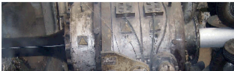
Figur 5. Ekstruder for påføring av PE-belegg på duktilt støpejernsrør. Støpejernsrør som er varmt og påført sinkbelegg kommer inn på høyre side. Ut av ekstruderen (på venstre side) krympes PE-belegg på røret.
