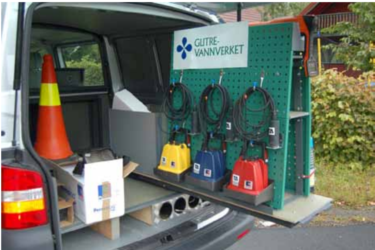
Figur 8. Lekkasjeutstyr fra GVD (tidligere Glitrevannverket) (Foto: Rene Astad Dupont)
