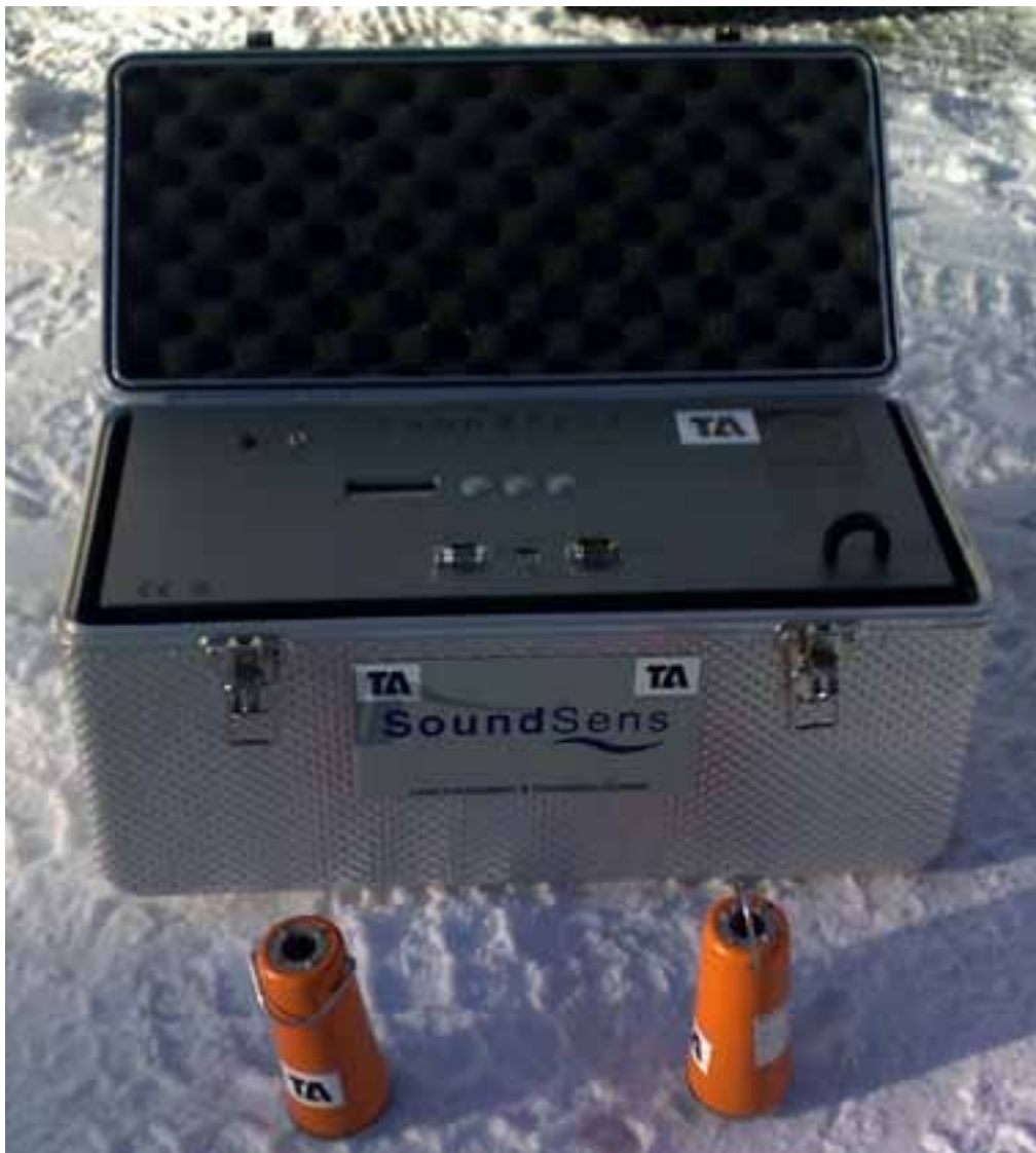
Figur 7. Korrelerende loggere (Foto: Rene Astad Dupont, GVD)
