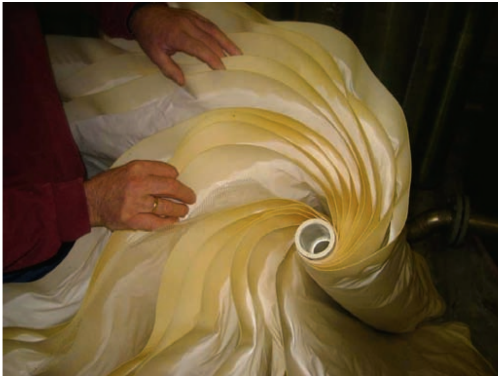
Figur 20. Utpakking av en membranmodul. I en membran vil det være et stort areal eksponert mot både råvann og rentvann.
