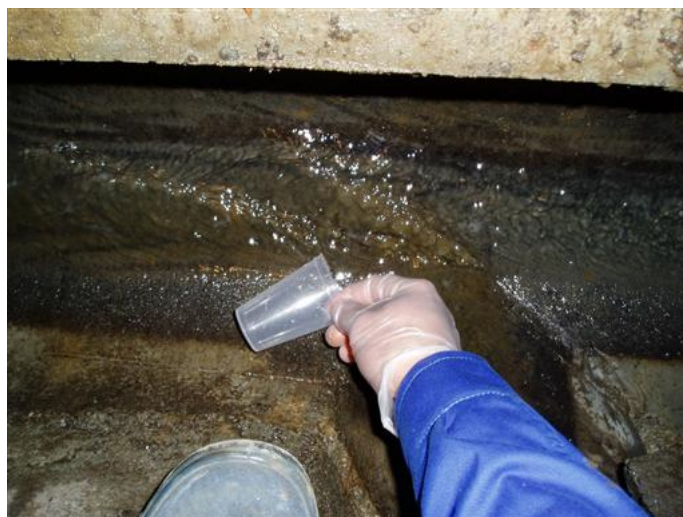
Figur 5.4 Uttak av biohudprøver fra rørveggen
