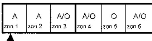
Figur 1. Utformning av biosteget samt olika processmöjligheter för respektive zon (A: Anoxisk zon, O: Luftad zon)
