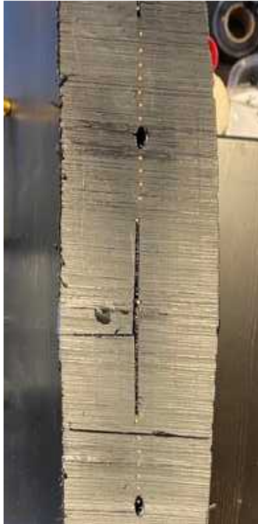
Bilde av elektromuffesveis
