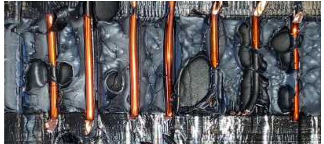
Vann i sveiseflaten
